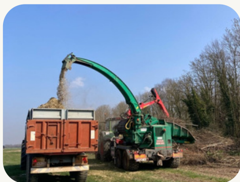
Chantier de broyage de branche avec broyeur à plaquettes combustible (©Greenotec et AWAF)
