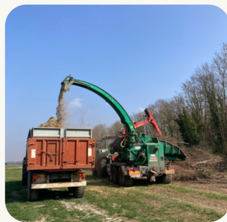
Chantier de broyage de branches avec broyeur à plaquettes combustibles (©Greenotec et AWAf)
